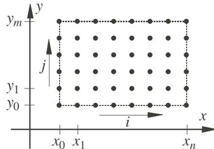
Un tipico esempio è il problema di calcolare la funzione di più variabili che determina la distribuzione di temperatura nell'ambiente nel caso in cui la variabile in esame, la temperatura, sia nota al contorno cioè nei punti segnati in tratteggio.
